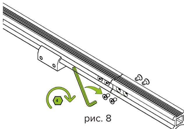
4. Выполните затяжку вкрученных винтов (8 шт.) при помощи динамометрического ключа с усилием 12 N.m.
